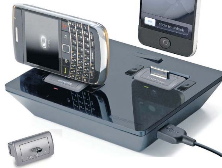
Eins für (fast) alle: Mit bis zu vier Adaptern für Mobilgeräte arbeiten die Ladestationen von ladapt, die auch über USB oder an der Autosteckdose Energie ziehen können.
