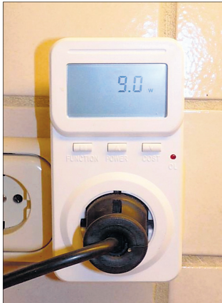
Das Energiekostenmessgerät zeigt neun Watt Standby-Verbrauch.
